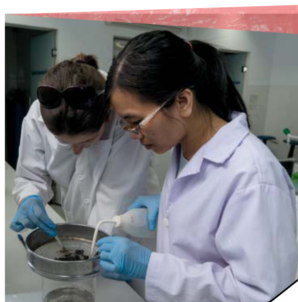
Extraction des microplastiques au laboratoire / Tách vi hạt nhựa trong phòng thí nghiệm / Microplastics extraction in the laboratory - Tp.HCM / Ho Chi Minh City - 2017 4
