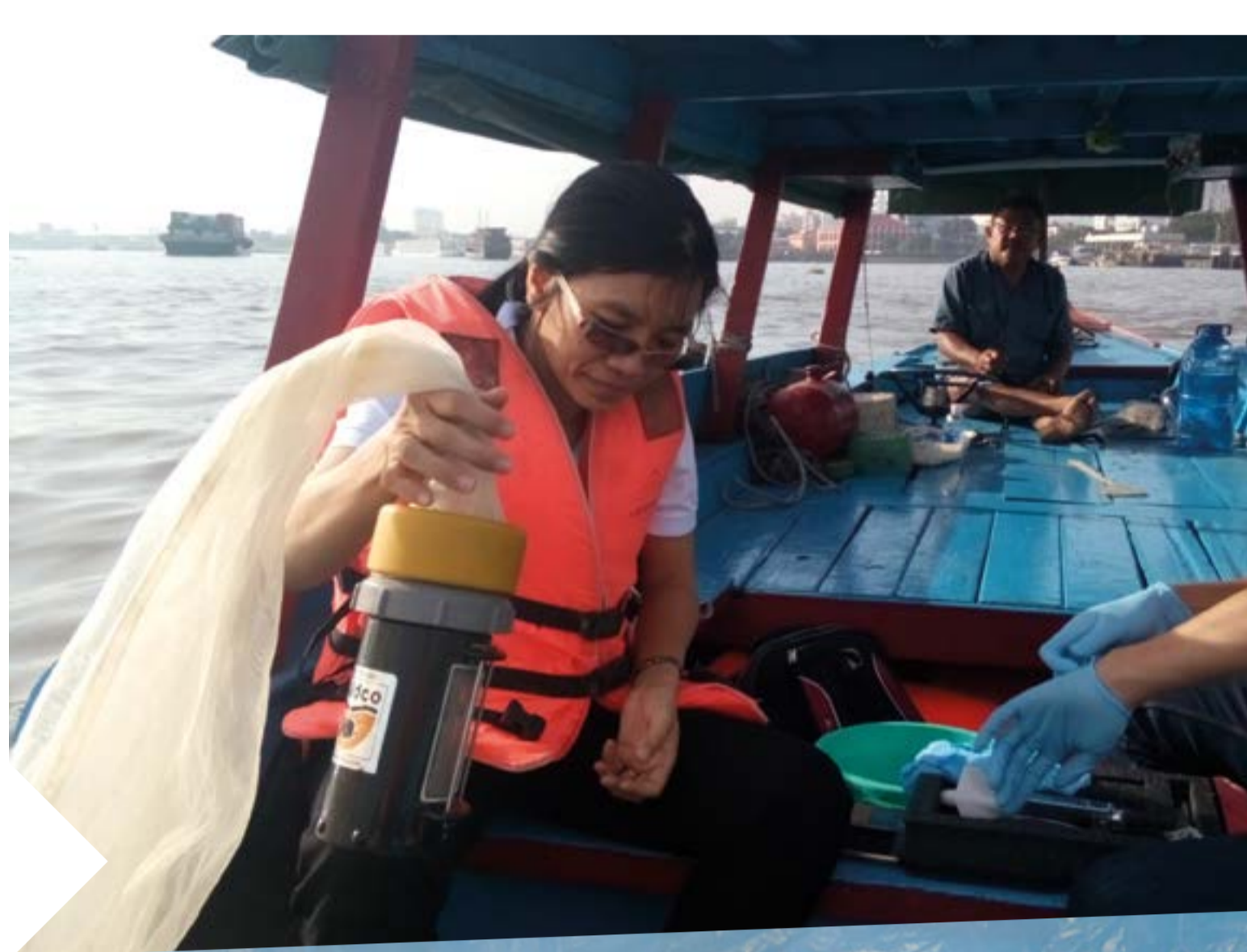
Echantillonnage de microplastiques avec un filet plancton / Lấy mẫu vi hạt nhựa bằng vợt lưới sinh vật phù du / Microplastic collection using plankton net - Sông Sài Gòn / Saigon River - 2017 1 2 3
